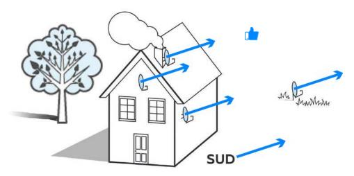
Votre parabole doit être orientée vers le sud/sud Est et vers le haut. Il est possible de l'installer en toute discrétion sur le toit, le pignon mais aussi sur un balcon ou dans le jardin (hors lieu de passage). Elle ne doit pas avoir de prise au vent. Le cerclage à une cheminée nécessite de s'assurer de la solidité sans faille de celle-ci.
