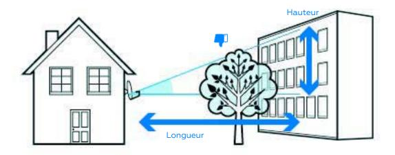
Si un obstacle (arbre, immeuble...) se trouve dans l'axe de visée du satellite, la parabole doit être placée à une distance minimum de 1,5 fois la différence entre la hauteur de l'obstacle et la hauteur de fixation de la parabole. Tenez compte du développement de la végétation qui pourrait empêcher la réception des signaux plus tard (feuillage, branches...).
