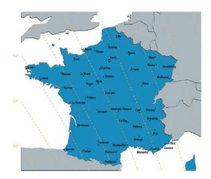
Exemple : à Biarritz, le LNB doit être tourné de 13° par rapport à la verticale, dans le sens des aiguilles d'une montre lorsque l'on regarde la parabole et que l'on est situé entre le satellite et la parabole.
