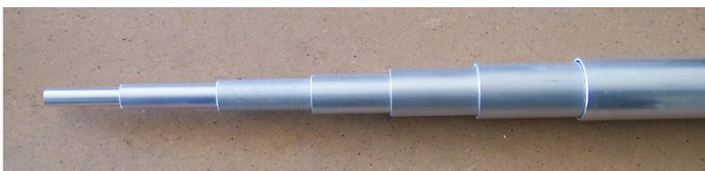
Placez le demi-dipôle sur un plan et commencez à extraire le plus petit diamètre. Faites correspondre le trou du tube intérieur avec celui du tube extérieur. Les éléments sont fixés en insérant le boulon du côté du trou le plus grand, de manière à ce que la tête cylindrique du boulon soit bien en retrait et repose sur le tube intérieur **Lubrifiez** légèrement le filetage des boulons pour éviter qu'ils ne se clouent (ce qui arrive fréquemment avec les boulons en acier inoxydable).
