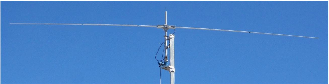
Après avoir terminé les opérations de mise en place, vérifiez et terminez le serrage de tous les écrous. Si le dipôle est monté au-dessus d'une yagi HF, il est préférable qu'il soit installé parallèlement au boom de la yagi et à une distance verticale d'au moins 1,5m. La présence d'objets métalliques ou d'obstacles à proximité peut également altérer de manière significative le bon fonctionnement de l'antenne.
