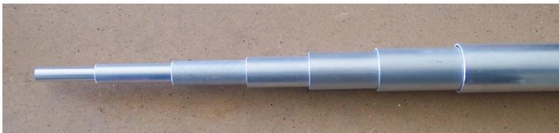
Placez le demi-dipôle sur un plan et commencez à extraire le plus petit diamètre. Faites correspondre le trou du tube intérieur avec celui du tube extérieur. Les éléments sont fixés en insérant le boulon du côté du trou le plus grand, de manière à ce que la tête cylindrique du boulon soit bien en retrait et repose sur le tube intérieur **Lubrifiez** légèrement le filetage des boulons pour éviter qu'ils ne se clouent (ce qui arrive fréquemment avec les boulons en acier inoxydable).
