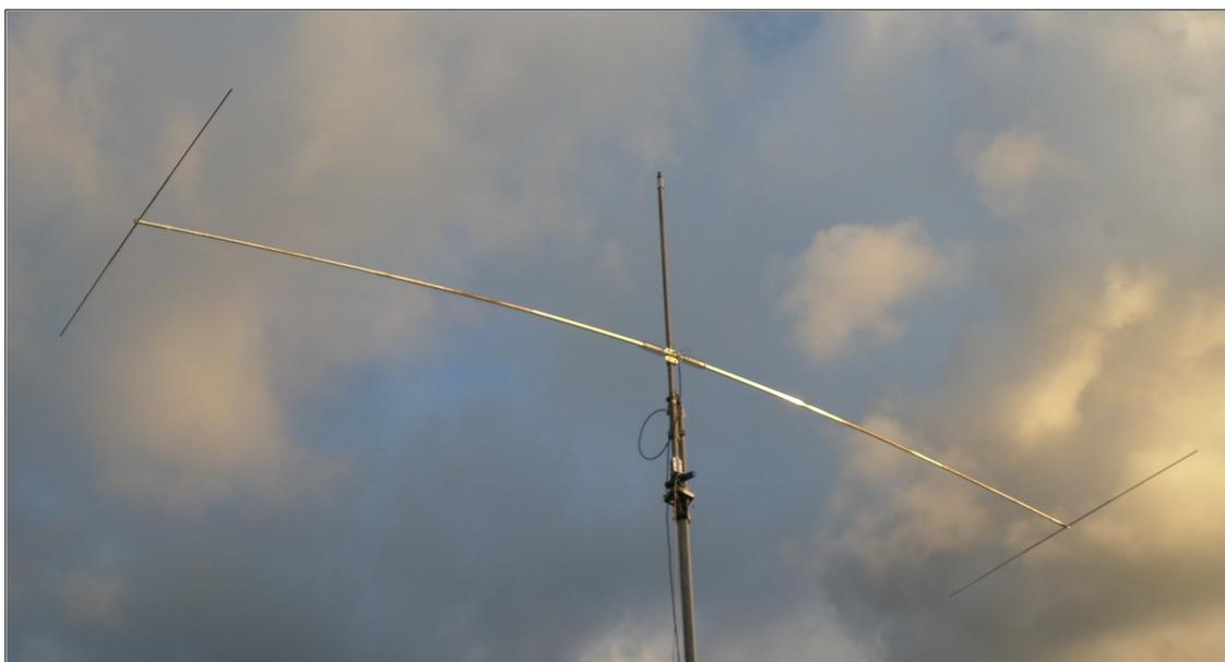
Après avoir monté l'antenne sur le mât, vérifier la résonance, si nécessaire modifier la position des capuchons capacitifs. Si l'antenne a un ros élevé, desserrer les pinces des bobines d'entrée et avancer ou reculer par très petits pas le long de la boucle de la bobine, symétriquement, jusqu'à ce que la meilleure adaptation d'impédance soit trouvée. Si elle est bien adaptée, l'antenne doit avoir un ros égal ou très proche de 1:1 au centre de la bande.
