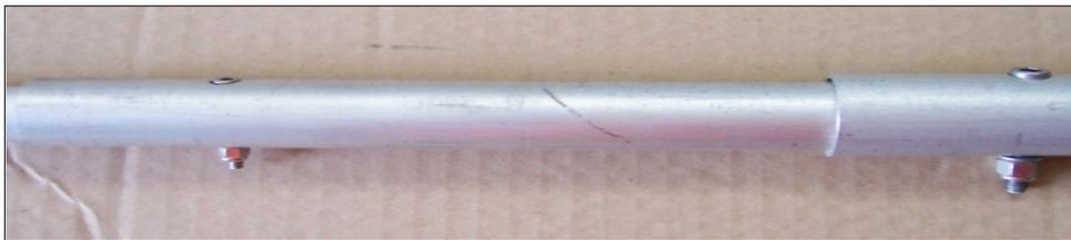
Serrez l'écrou. Veillez à ce que toutes les têtes de goupilles soient du même côté. En utilisant la même technique, retirez et joignez toutes les sections.
