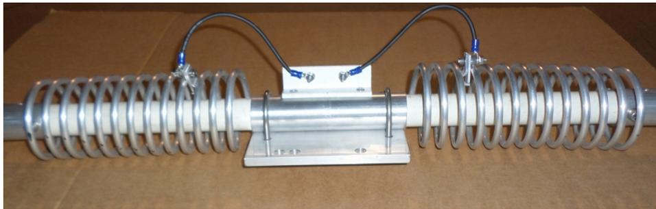
Si vous avez acheté la version balun (1:1), installez le balun directement sur les boulons du dipôle, en prenant soin de fixer le coaxial de manière à ce que le poids ne porte pas sur le balun lui-même. Dans la version sans balun, connecter le coaxial, après l'avoir ouvert à un V, directement aux deux boulons d'entrée. Des corrections d'accord sont possibles en déplaçant légèrement et symétriquement les deux bornes sur les bobines. La photo montre un exemple de l'aspect final possible.
