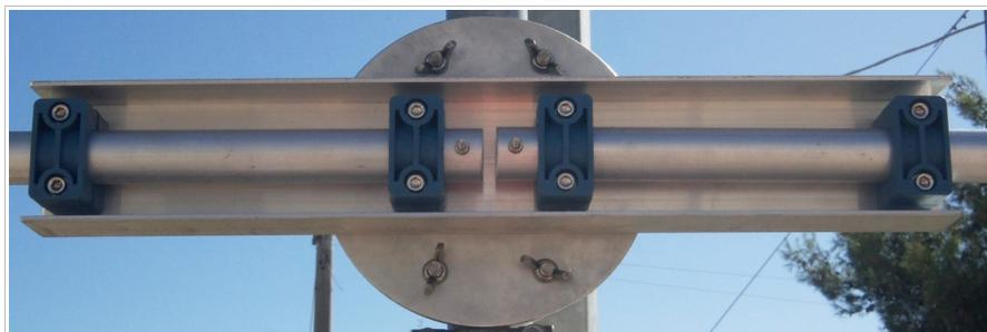
Si vous avez acheté la version balun, connectez les cavaliers aux boulons des demi-pôles et fixez le corps du balun au mât afin qu'il ne reste pas libre de se balancer dans le vent.
