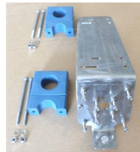
Installer les 4 boulons 4x25MA (pour les radiaux à fil) dans les trous en forme de X (les boulons intérieurs ne sont utilisés que dans la version des radiaux pleins). Sur l'un d'entre eux sera placée une extrémité de la borne de l'œillet de l'étrangleur RF. La séquence d'assemblage correcte pour tous les boulons est la suivante : boulon, rondelle dentelée, écrou normal, deux rondelles plates et écrou autobloquant.
