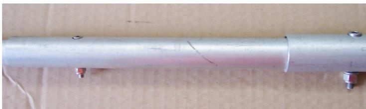
**Lubrifiez légèrement le filetage de tous les boulons avant de les installer (le SS a tendance à se clouer très facilement).**
