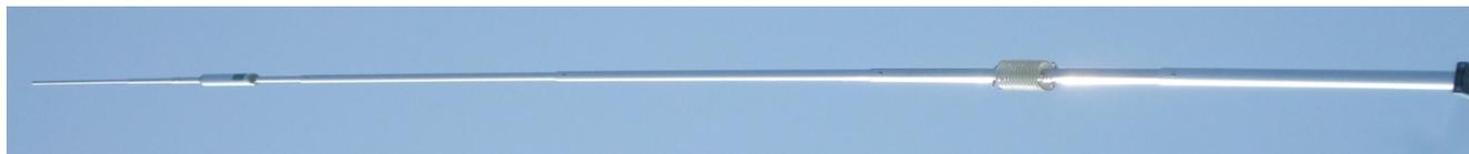
La section de tuyau sous le piège et le sommet ont plusieurs trous qui sont utilisés pour effectuer de petits ajustements de réglage sur les deux bandes. Réglez d'abord la bande 30m, puis la bande 40m. L'allongement diminue la fréquence, le raccourcissement l'augmente.
