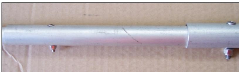
Serrez l'écrou. Veillez à ce que toutes les têtes de goupilles soient du même côté. En utilisant la même technique, tirez et joignez toutes les sections, à l'exception de la section de plus grand diamètre qui doit être assemblée, d'abord à la base, puis à l'assemblage final.
