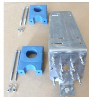
Installer les 8 boulons 4x25MA sur les trous en X et le boulon 4x16 sur le trou latéral comme indiqué sur la photo. Séquence correcte pour tous les boulons : boulon, rondelle moletée, écrou normal, 2 rondelles plates et écrou autobloquant. **Fixer tous les boulons en serrant l'écrou normal.**
