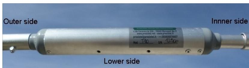
Lorsque les deux semi-éléments sont prêts, préparez les centres des deux radiateurs comme indiqué sur la photo et le dessin.
