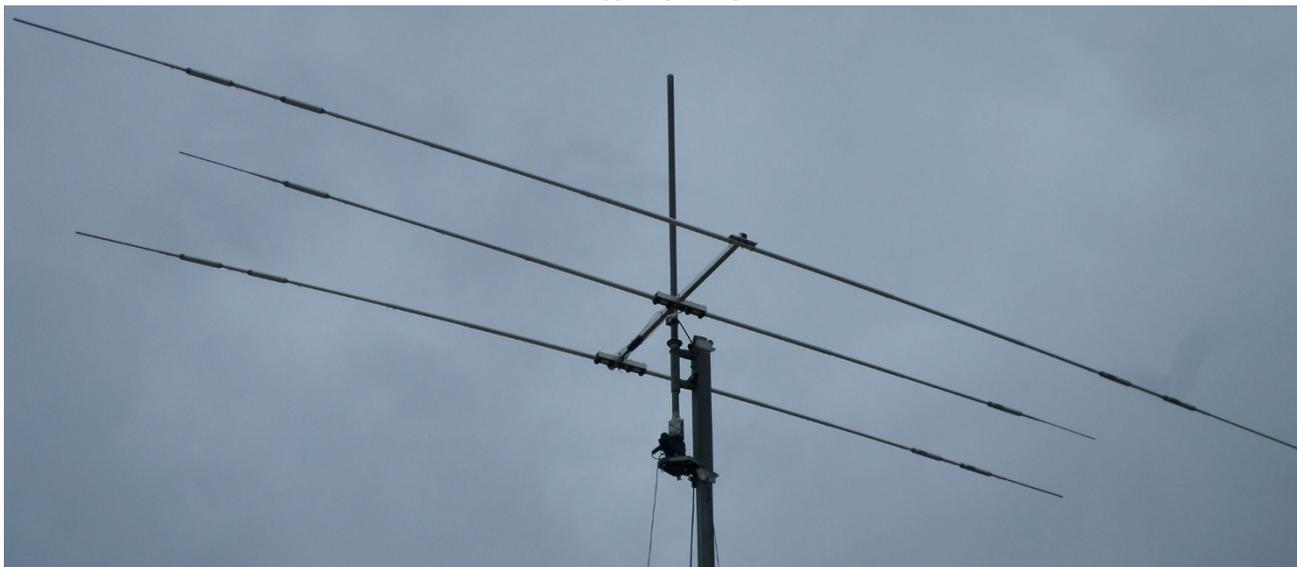
**Pour une meilleure performance, il est recommandé de l'installer à une hauteur d'au moins 5-6 m au-dessus du sol.**
