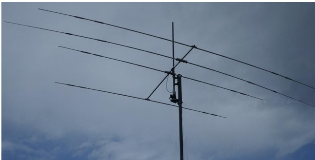
**Pour des performances optimales, il est recommandé de l'installer à une hauteur d'au moins 8 à 10 m au-dessus du sol.**
