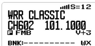
2. Tournez le bouton **SQ** à fond dans le sens inverse des aiguilles d'une montre, puis dans le sens des aiguilles d'une montre jusqu'à ce que le bruit s'arrête (niveaux 00 - 19).
