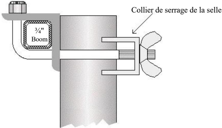
Support de montage pour les antennes avec des flèches carrées de 3/4".
